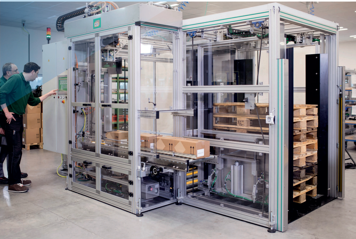
Die Verpackungsmaschine mit Pick-and-Place-Palettierroboter ordnet befüllte und verschlossene Kartons schnell und legt sie geordnet auf Paletten ablegt
