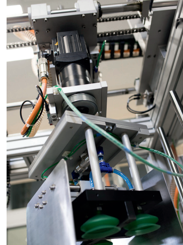
Das Vier-Achs-gesteuerte Saugsystem – das hochpräzise Planetengetriebe ist mit dem dynamischen Servomotor ohne Motoradapter direkt miteinander verheiratet. Das spart Bauraum, verringert das Gewicht, ist leise und dynamisch.
